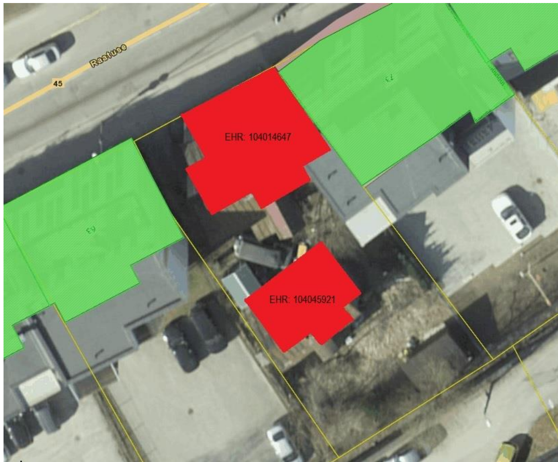
Joonis 1. Raatuse 69, 71 lammutatavate hoonete asendiplaan (lammutatavad hooned on tähistatud punase hulknurgaga).
