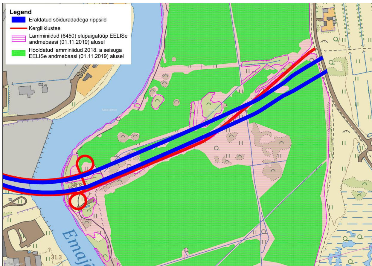
Joonis 3.16 Rippsilla alamvariant kui sõidusuunad paiknevad eraldi sildadel. Aluskaart: Maaamet, 2019.
