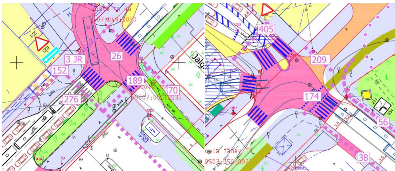
Skeem 8. Jalakäijate liiklustihedus võistluslalal. Jalakäijate (JR jalgratturite) arv tööpäeval kl 12-13. Vasak skeem on Kaluri ja Soola tn ristmikust, parempoolne Soola ja Väike-Turu ristmikust. Allikas Liikluslahendus OÜ.
