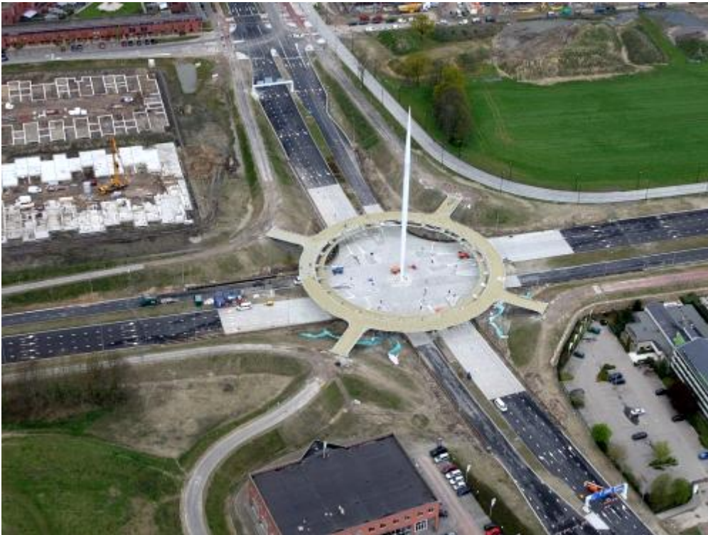
Skeem 4.5.2.1: Põhimõtteline näide kergliikluse jaoks loodud ringristmikust – jalgsi ja jalgrattaga liiklejad on viidud teisele tasandile. Tartu puhul ei pruugi olla vajalik lahendus ringristmikuna, ent eritasandilise ühenduse otstarbekust tuleks täiendavalt kaaluda. Samuti tuleb Tartu kesklinna kavandatava lahenduse puhul läbi viia ümbritseva keskkonna iseloomu ja mastaapi arvestavate tingimustega väliruumi kujunduskonkurss. Foto: www.ed.nl
