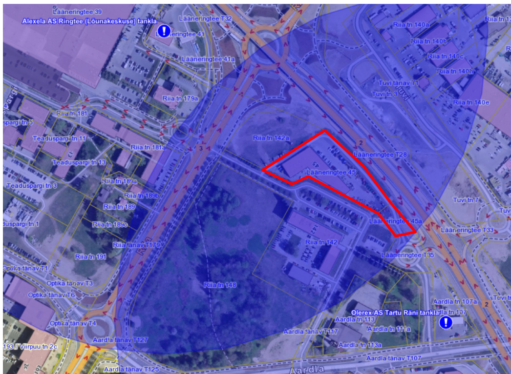
Skeem 2. Väljavõtte Maa-ameti ohtlike ettevõtete kaardirakendusest. Punasega tähistatud planeeringuala, sinisega ohtlike ettevõtete (tanklad) ohualad.
