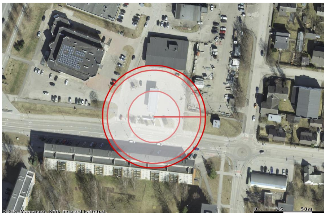
Joonis 4. Laadimisel lekkiva LPG aurustunud gaasipilve plahvatuse ülerõhu ja süttimisel soojuskiirguse ohualad: Ro (ülerõhk): 40 m; Ro (soojuskiirgus ehitistele): 22 m; Ro (soojuskiirgus inimesele): 44 m.
