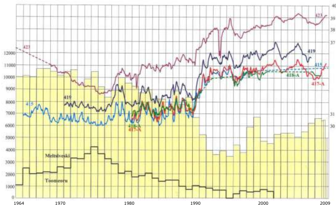
Joonis 7. Veetarbimine Tartu kvaternaari veehaaretest ja veetasemed vaatluspuurkaevudes 1964.-2009. a. [AS Tartu Veevõrk]
