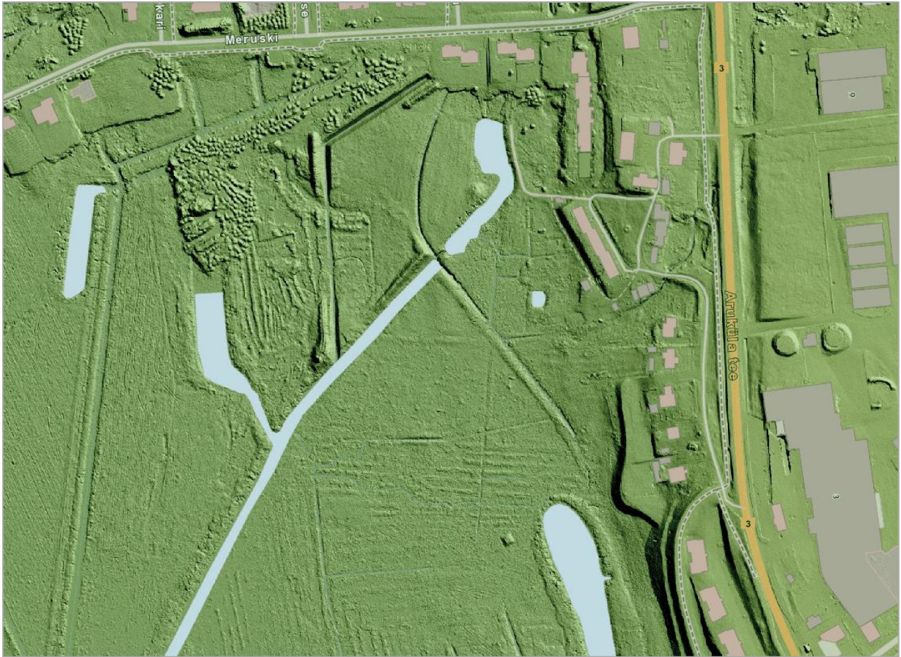
Joonis 9. Aruküla tee ja Meruski tänava juures läbiviidud ning pooleni olevad maapinna täitmistööd (Maa-ameti geoportaali maainfo kaardirakenduse reljeefi kaart, 27.04.2022).
