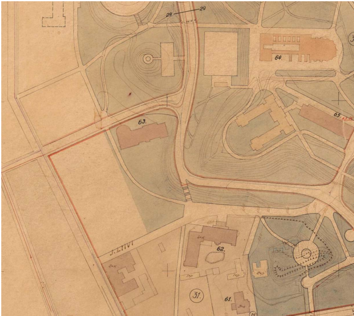
Joonis 23. Väljavõte 1950. a tänavate punaste joonte plaanist, kus planeeringualal on näidatud Näituse tänava laiendamine, mille eelduseks oli olemasoleva Näituse tn 6 tänavaäärse hoonestuse lammutamine. Uus anatoomikum (joonisel tähistatud nr 63 kui patoloogia ja füsioloogia instituut) asub tänavast nii kaugel, et seda ei oleks pidanud puutuma. Nr 62 on meteoroloogia observatoorium ja riigi keskarhiiv. Allikas: Rahvusarhiiv, EAA, f 2072, n 9, s 787, leht 1 (ENSV arhitektuuri valitsus, 05.01.1950).
