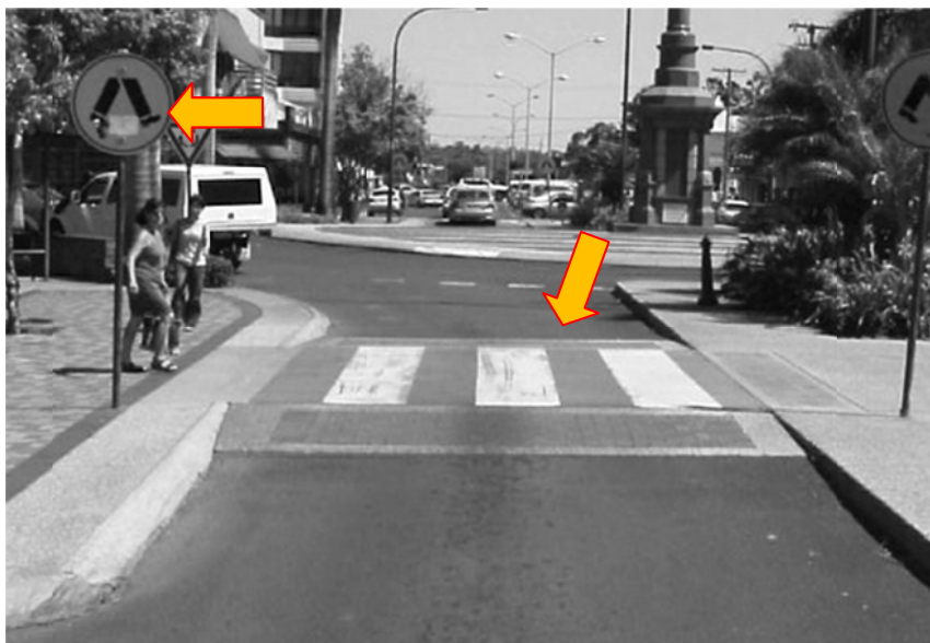
Foto 3.3.1.2: Tõstetud ülekäigurada kombineerituna mootorsõidukijuhte hoiatavate märkidega. Ühtlasi toimub kergliikleja liikumine samal tänavatasapinnal – liikumine on häiringuta ja sujuv. Allikas: The Local Government & Municipal Knowledge Base, lgam.wikidot.com.
