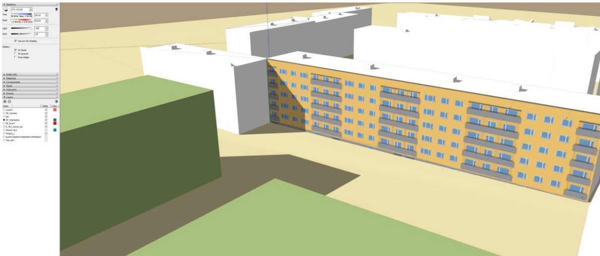
Skeem 9. Insoltsiooni lõpp uuritud aknas planeeringu elluviimise järgselt kl 9:20 (ametlik suveaeg 10:20), kui akent hakkab varjama olemasoleva naaberhoone Mõisavahe tn 24 nurk vasakul. Planeeritud hoone võimalik suurima ulatusega paiknemine on rohelse tooniga.
