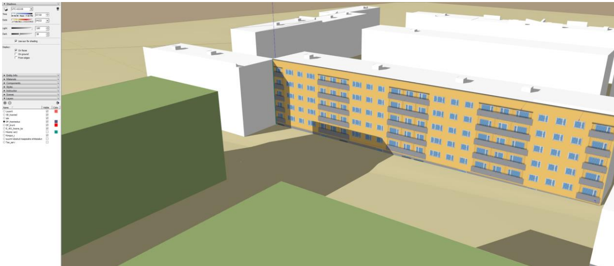
Skeem 8. Insoltsiooni algus uuritud aknas planeeringu elluviimise järgselt kl 7:50 (ametlik suveaeg 8:50), kui taandub võimalik uue Mõisavahe tn 21 hoone vari. Planeeritud hoone võimalik suurima ulatusega paiknemine on rohelse tooniga.
