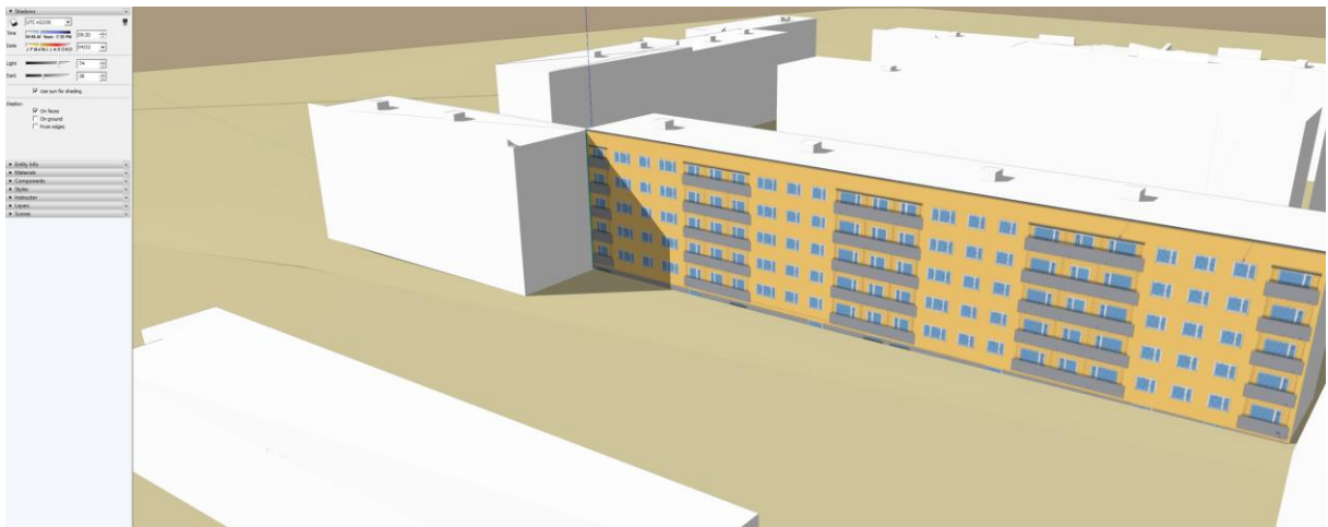
Skeem 7. Insolatsiooni lõpp uuritud aknas olemasolevas olukorras kl 9:20 (ametlik suveaeg 10:20), kui akent hakkab varjama olemasoleva naaberhoone Mõisavahe tn 24 nurk vasakul.
