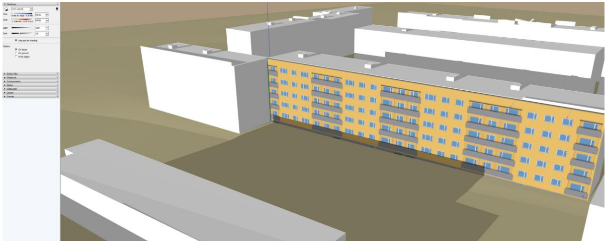
Skeem 6. Insolatsiooni algus uuritud aknas olemasolevas olukorras kl 6:00 (ametlik suveaeg 7:00), kui olemasoleva Mõisavahe tn 21 hoone vari taandub.
