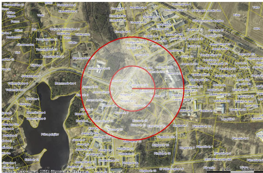
Joonis 1. Bensiini tsisternauto BLEVE ohualad: Ro ehitistele 191 m, Ro inimestele: 434 m.
