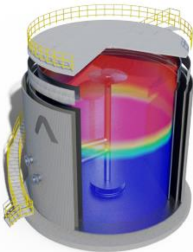
Skeem 3. Energiasalvesti tööpõhimõtte illustratsioon. Punasega on soe vesi ning sinisega külm vesi. Nende vahel on segunenud temperatuuriga kiht.
