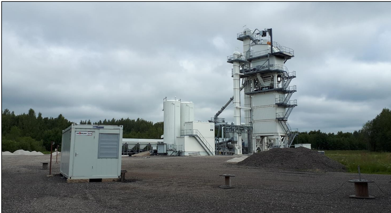
Joonis 2. Kardla baasi katastriüksusel asuv asfaltbetoonisegisti (foto: Kobras OÜ, pildistamise aeg 07.08.2020)
